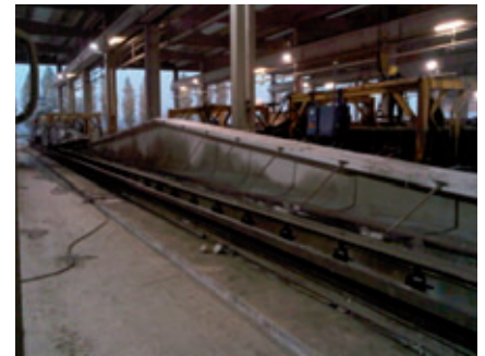
Fig. 6b: Elemento stagionato al vapore
